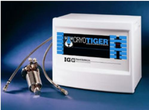
1. [Pérdida de funcionamiento de un sistema Cryotiger por bloqueo de orificio en el 'cold head', y cómo purgar el sistema.](#) [1]
