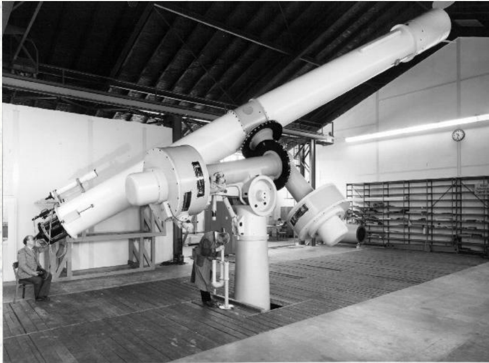
Refractor de 650 mm en la sala de montaje de la fábrica de Zeiss. Observador en el extremo del ocular y en el lugar para la lectura fina de la rectascensión. Tubo oeste. Vista desde el este.
